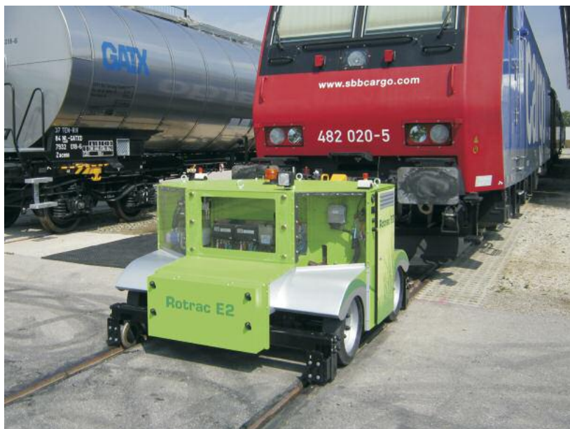
Zweiwege-Rangiergerät Rotrac E2. Die Achsen mit je zwei 4,5 kW-Asynchron-Motoren stammen aus der Elektro-stapler-Serienproduktion
