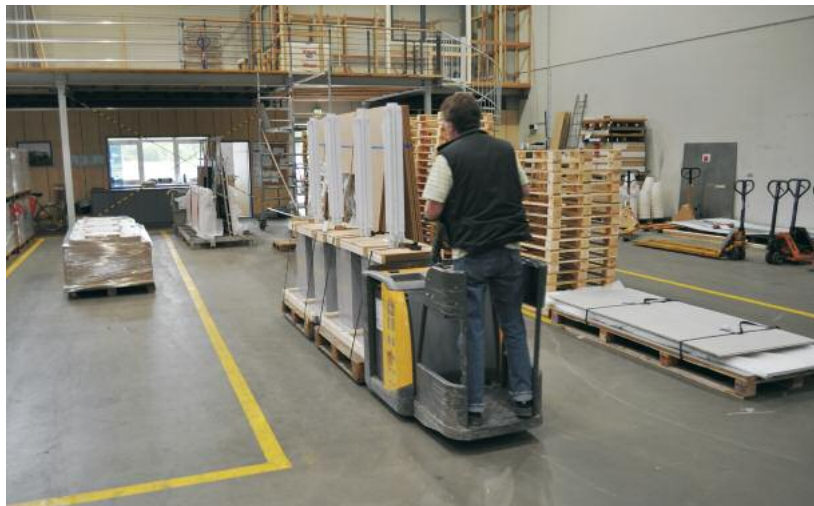
Atlet-Elektrohubwagen PLP mit fester, stabiler Fahrerstandplattform und langen Gabeln für den Transport langer und sperriger Ware
