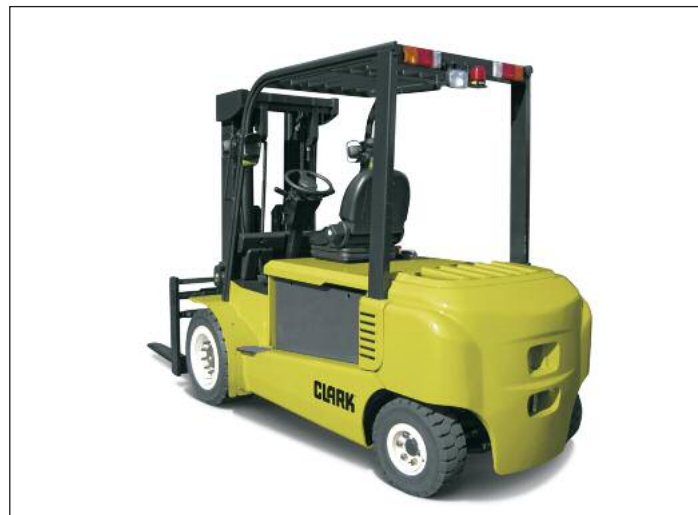
Der neue 80-V-Elektro-Vierradstapler GEX 40-50 von Clark in Drehstromtechnologie komplettiert die GEX-Baureihe
