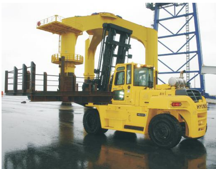
Die schweren Stapler – hier der I60D-7E mit 16 t Tragkraft – erreichen Geschwindigkeiten von über 30 km/h
