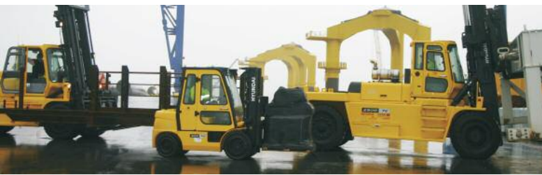
Von 3 bis 25 t reicht die Tragkraft der drei Dieselstapler, die auf dem Werksgelände von CSC unterwegs sind. Zusätzlich wird ein Elektro stapler mit 5 t Tragkraft im Lager eingesetzt
