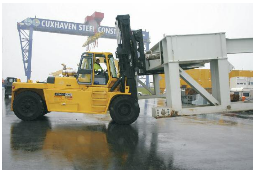
Der schwerste Dieselstapler von Hyundai, der 250D-7E mit 25 t Tragkraft, absolviert bei CSC seinen ersten Einsatz in Deutschland
