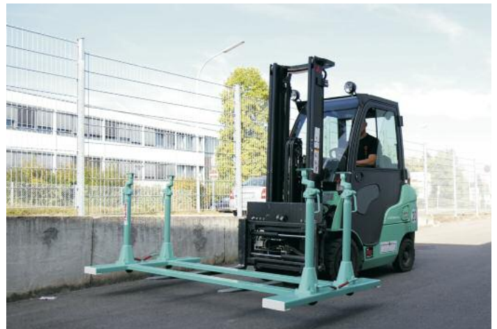
Der Sportgerätehersteller Benz setzt zwei neue Dieselstapler von Mitsubishi ein – einen Grendia FD20N und einen FD40K. Der Zweittonner FD20N arbeitet in der Schlosserei. Hier transportiert er die Stahlkonstruktion für einen Barren
