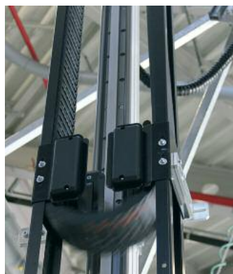
Die Kette ‚erträgt‘ auch Querbeschleunigungen
